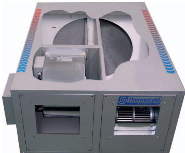
IT Unità ventilanti orizzontali a doppio flusso con recuperatore di calore rotativo igroscopico e ventilatori centrifughi.
